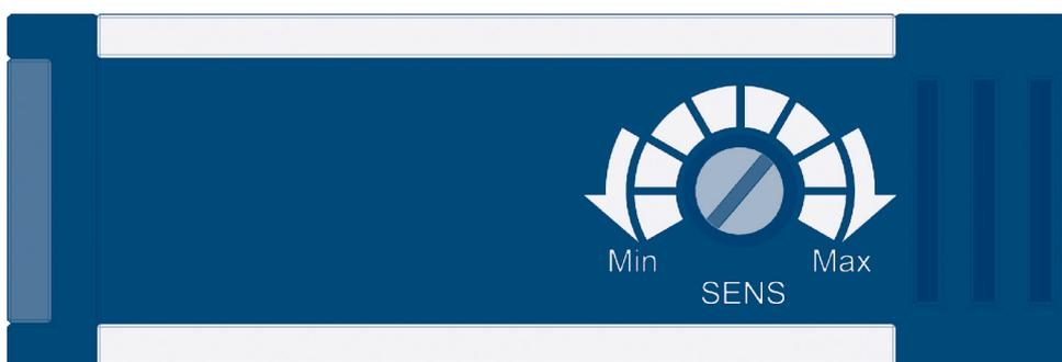
При необходимости отрегулируйте чувствительность датчика так, чтобы он четко срабатывал, как только автомобиль окажется в положении «Припаркован к доку».
